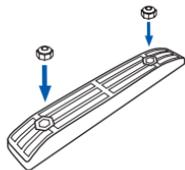
**Montage** Der Adapter lässt sich auf üblichen Gepäckträgern bis 145mm Breite montieren. Muttern in die Befestigungsbrücken eindrücken. Adapter mit der roten Taste nach vorn auf den Gepäckträger setzen. Position so wählen, dass bei aufgesetztem Zubehör genügend Abstand zu Sattel und Pedal bleibt.
