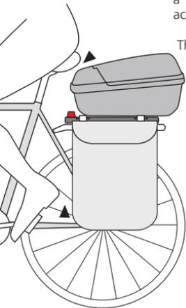
Selon le ou les accessoire qui seront fixé dessus, l'adaptateur devra être fixé sur le porte bagages de telle sorte que leur manipulation soit aisée, et n'entrave pas les mouvements du cycliste et que leur avancée n'accroche pas la selle. Retirer au besoin le tendeur de porte-bagages. Fixer l'adaptateur avec une des barres de fixation à l'avant et la seconde à l'arrière. 2 positions sont possibles. Serrez les vis jusqu'à ce que la plaque ne bouge plus (1,5-2Nm).
